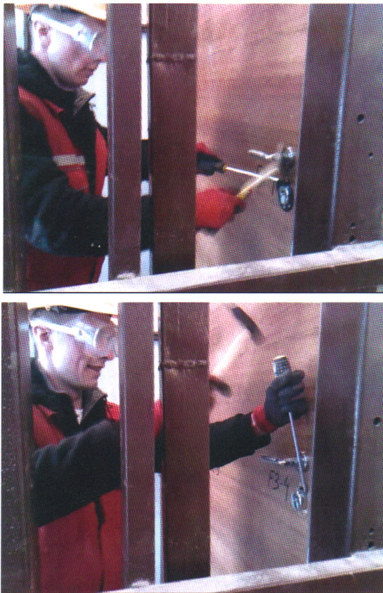
Slika 4. Ispitivanje za određivanje otpornosti na provalu priručnim alatom
