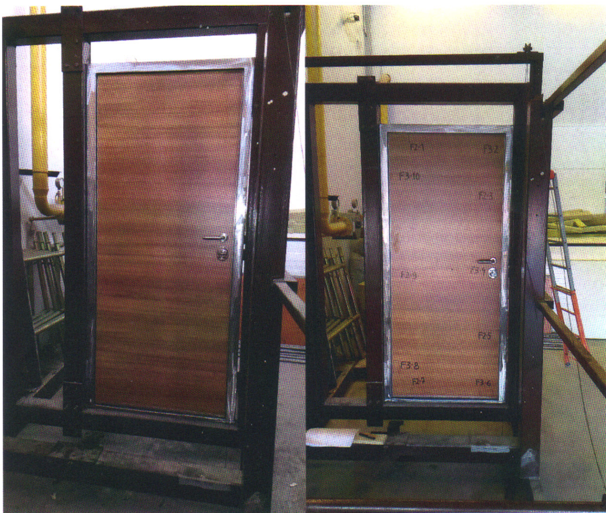
Slika 2. Ispitivana vrata montirana na konstrukciju rama (lijevo) i ispitne tačke (desno)
